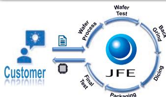
当社は独自のSIS(シリコンインテグレーションサービス)を提供しています。従来のウェハ形態でのファウンドリーサービスに加え、お客様の希望に応じた形態での納入を実現するため、各プロセスのパートナーメーカーと協力しながら、当社の在庫機能や物流機能を活かし、フレキシブルかつ高付加価値なターンキーサービスが提供可能です。ウェハ製造に続いて、ウェハテスト、パンプ、組立や最終テストなど、最終製品が出来上がるまでの各プロセスをサポート可能であり、また各プロセス個別対応も行っています。
